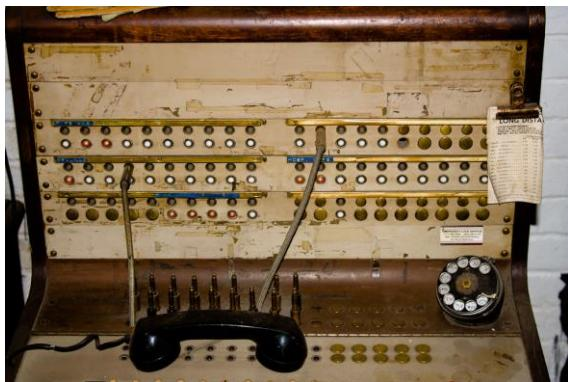
*Switchboard* yaitu alat komunikasi yang terdiri dari papan panel yang lebar, yang di dalamnya terdapat saklar-saklar dan instrumen lain yang berfungsi untuk menyampaikan informasi dari tempat satu ketempat lain. Saat ini *Switchboard* masih digunakan untuk keperluan intern kantor
